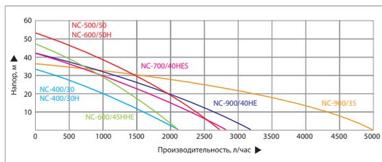
Приведенные характеристики справедливы при нулевой высоте всасывания и минимальных сопротивлениях потоку во всасывающей и напорной магистрали, при напряжении питания 220 В.
