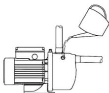
Труба всасывающей магистрали присоединяется к входному резьбовому отверстию, находящемуся на торце насосной части. В начале (от источника водозабора) всасывающей магистрали рекомендуется установить обратный клапан с сетчатым фильтром грубой очистки воды.
