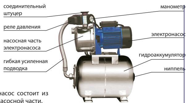
Поверхностный центробежный электронасос состоит из однофазного асинхронного двигателя и насосной части.
