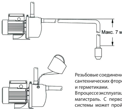
Резьбовые соединения трубопроводов следует выполнять с применением сантехнических фторопластовых лент или льна со специальными пастами и герметиками.
