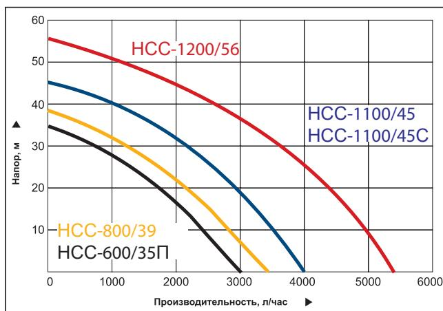
Приведенные характеристики справедливы при нулевой высоте всасывания и минимальных сопротивлениях потоку во всасывающей и напорной магистрали, при напряжении питания 220 В. Следует иметь в виду, что при увеличении высоты всасывания, а также при отклонении напряжения питания характеристики насосов ухудшаются.
